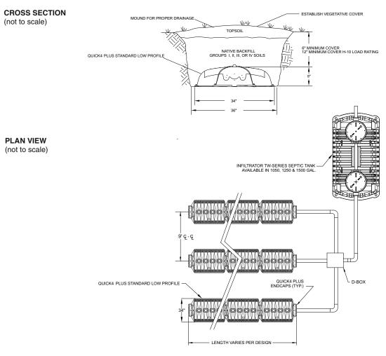
NOTE: MINIMUM 3" ELEVATION DROP REQUIRED FROM D-BOX TO END CAP INLET INVERT
